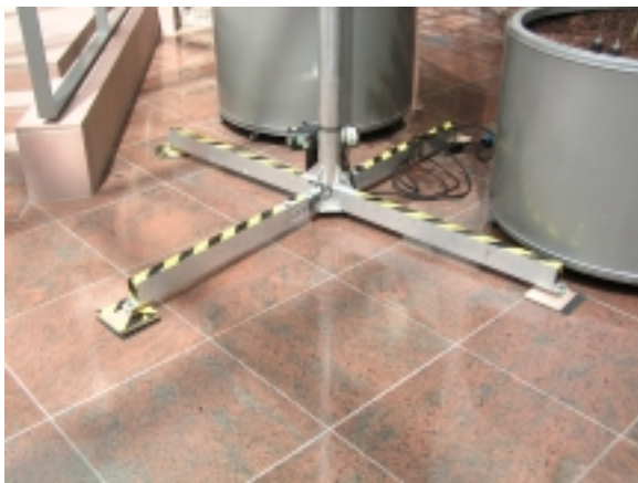
Babytower freistehend 7m hoch. Antrieb 136er Lodestar Kettenzug eingeschert, am Basement angeschlagen und gesichert. Sicherung Version 4 am Kettenzug.
