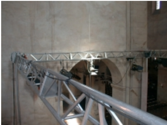
Hochgefahrenes und gesichertes Babytower – Rigg Höhe 7m Unterkante Traverse, Antrieb BGV D 8 Lodestar 136 kg eingesichert.
