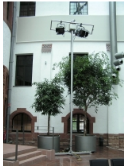
Babytower freistehend 7m hoch. Antrieb 136er Lodestar Kettenzug eingeschert, am Basement angeschlagen und gesichert. Sicherung Version 4 am Kettenzug.
