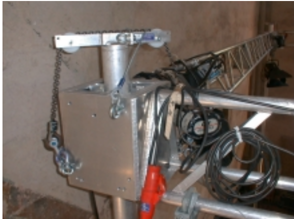
Hochgefahrenes und gesichertes Babytower – Rigg Höhe 7m Unterkante Traverse, Antrieb BGV D 8 Lodestar 136 kg eingesichert.
