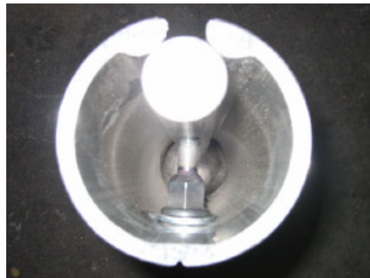
Offenes „C“ – Profil mit Spreizeinrichtung
