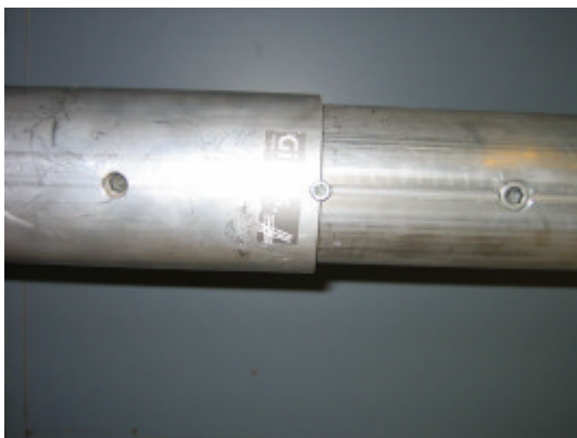
Eingesteckter Verbinder mit Bedienöffnungen und Führungzapfen
