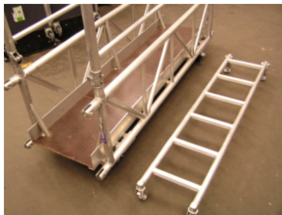
Durchstiegleiter (wird fest montiert APS 160)
