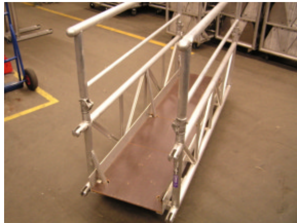
Geländer hochgeklappt und eingerastet
